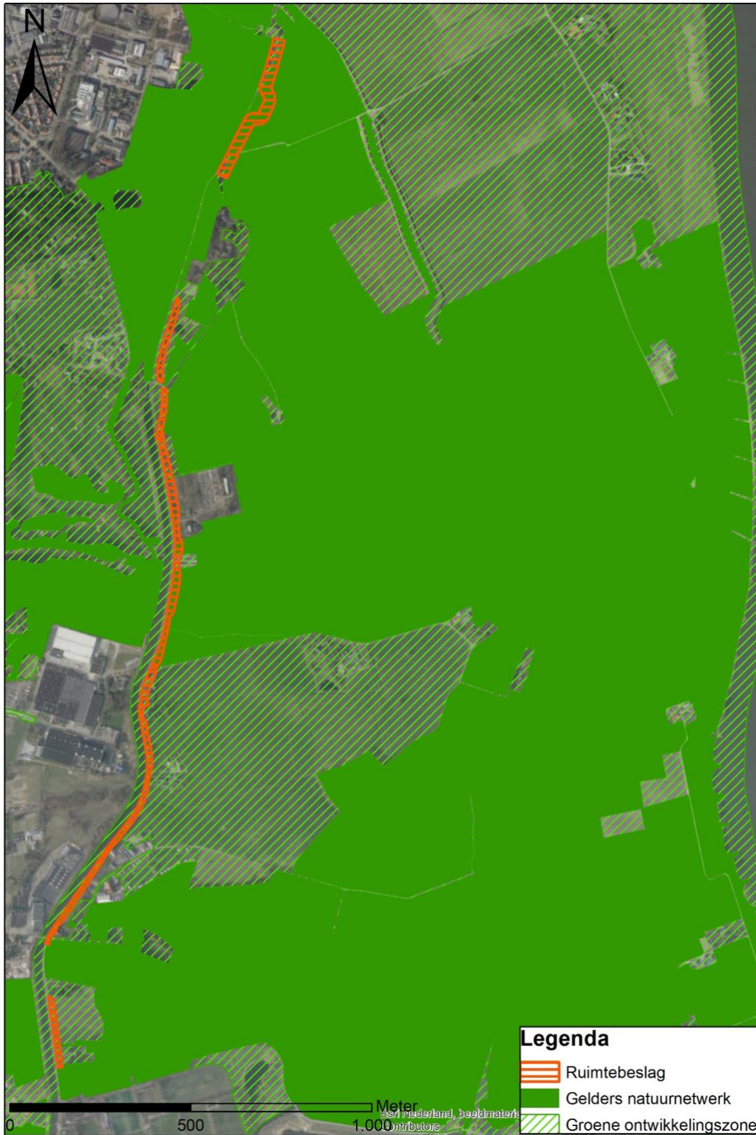
Figuur 6-2 Overlap ruimtebeslag dijkverbetering en Groene Ontwikkelingszone
