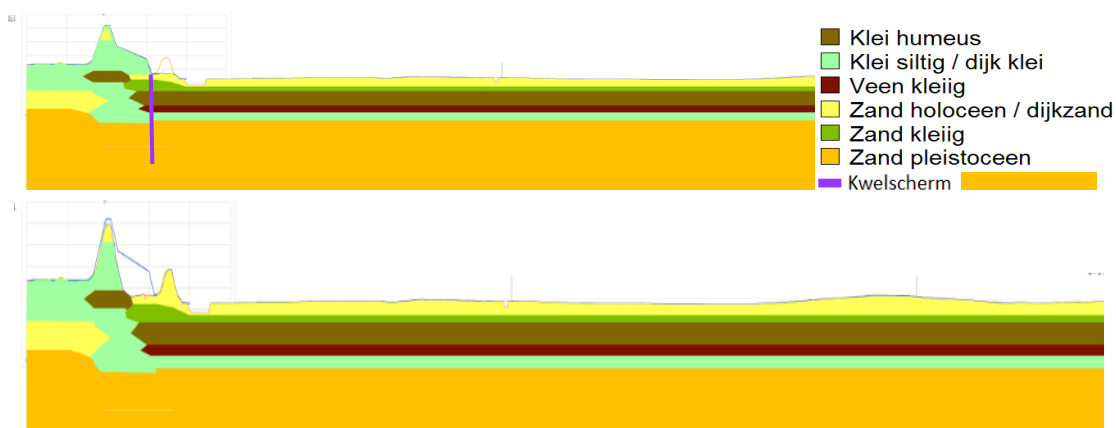
Figuur 2.1 Schematisatie profiel 1b met kwelscherm en aanpassingen dijkprofiel (boven) en huidige situatie (onder)
