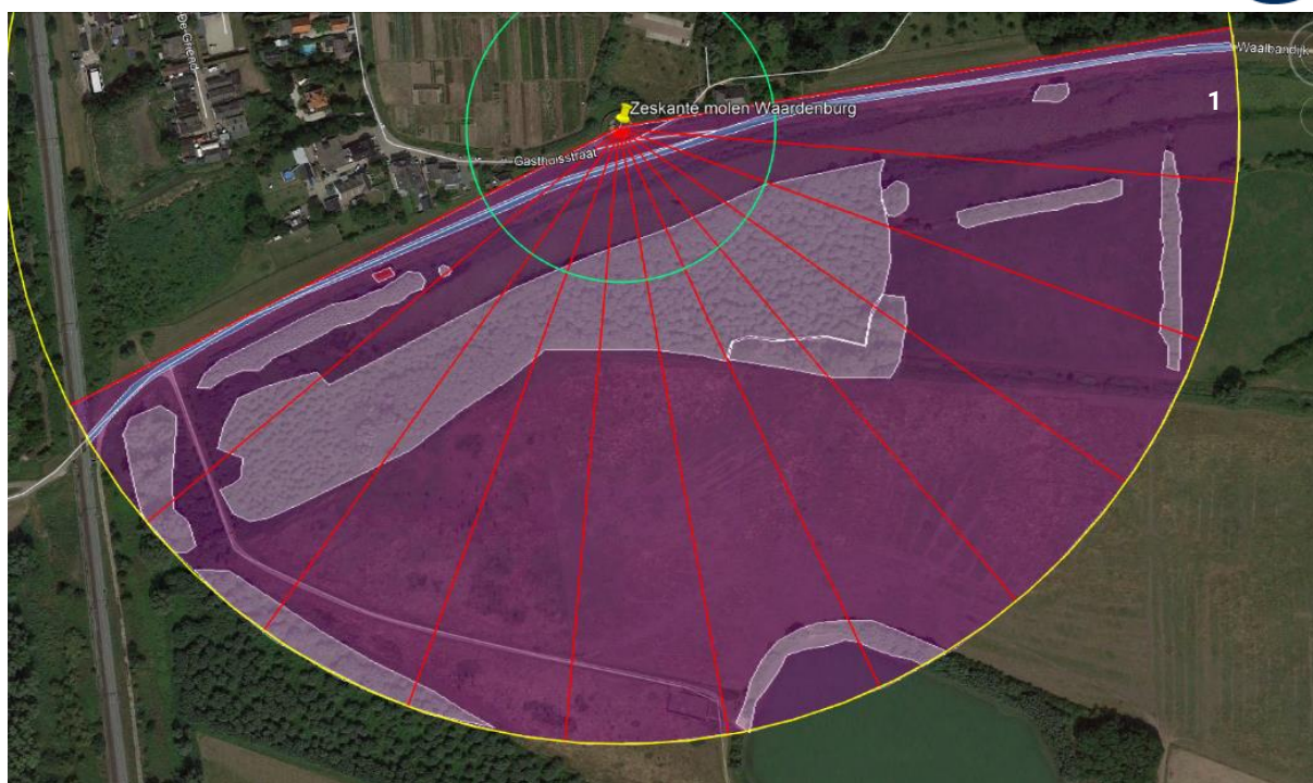
Afbeelding 2: Het rekengebied. De uiterste raaklijnen van de Waalbandijk binnen een straal van 400 meter van de molen zijn 80^\circ en 245^\circ . Ten behoeve van de het onderzoek is het rekengebied gesplitst in 11 sectoren van 15^\circ . Op basis van metadata van het KNMI kan het windregime van het dichtstbijzijnde KNMI-weerstation berekend worden per sector. Sector 1 is de hoek tussen 80 en 95^\circ , de nummering van de sectoren telt op met de klok mee. De dunne blauwe streep is de Waalbandijk. (Bron: Google Earth).
