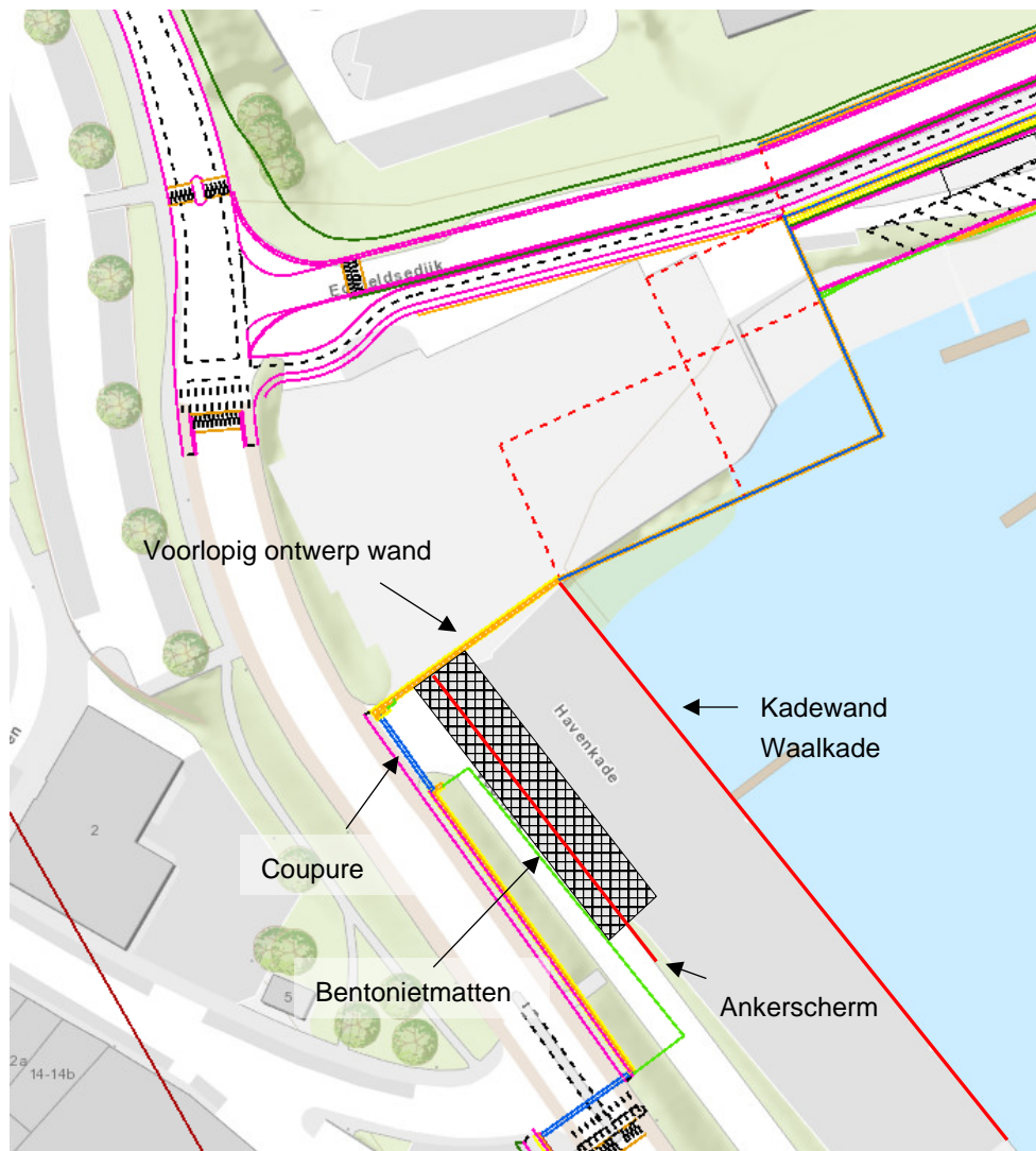
Figuur 5.2 Bovenaanzicht deeltraject 3B en deeltraject 4A-1 met voorlopig ontwerp
