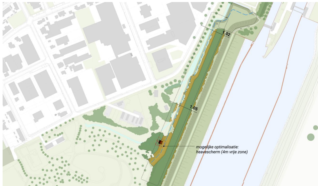
Figuur 2.4 Voorhavendijk: locatie filterscherm (blauwe stippellijn) en zone waar begroeiing wordt gekapt (oranje)
