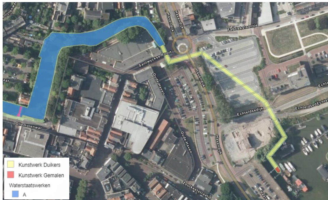
Figuur 4.2 Verbinding van de Stadsgracht met de Vluchthaven via een duiker en pompemaal (bron: Legger Waterschap Rivierenland)
