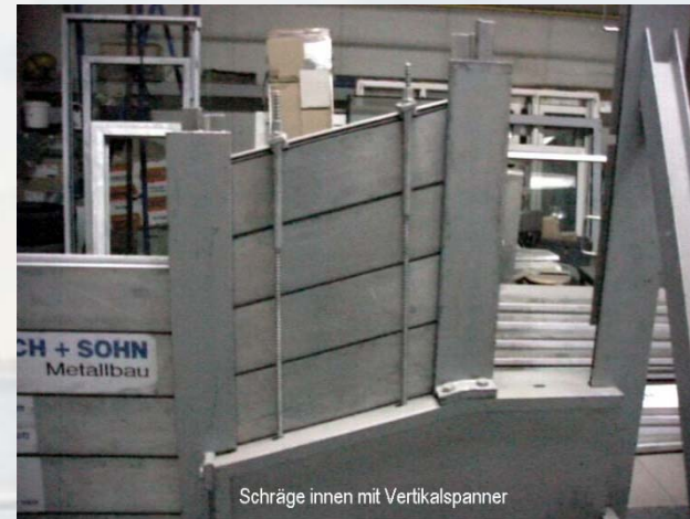
Hoogtevergang door schuine schotbalken en hoekse voetpunten van de steunen
