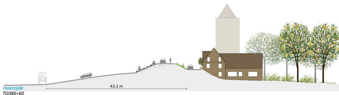
Figuur 3-4 Dwarsprofiel dijkvak 16c (TG086+60)
