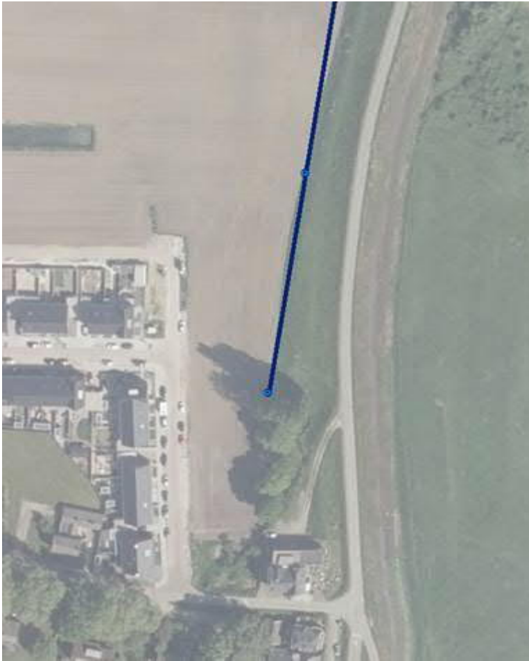
Figuur 4-1. Drainagebuis binnendijs (blauwe lijn) (bron: legger waterkeringen WSRL)
