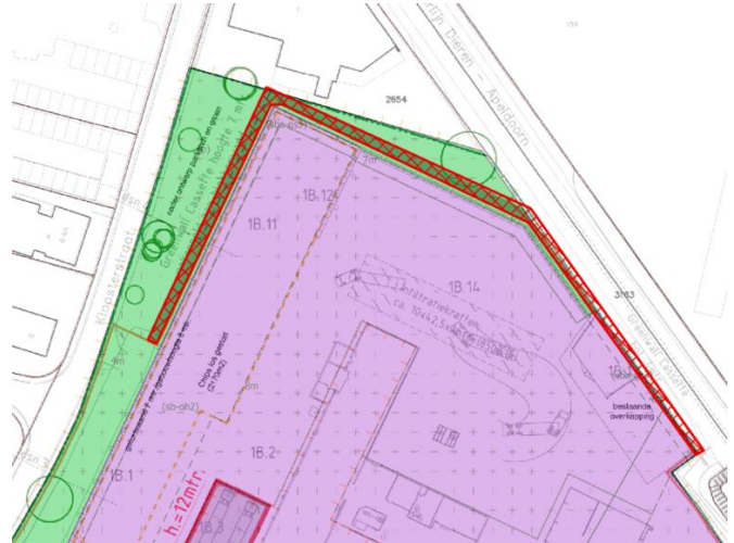
Figuur 8 Uitsnede strijdigheid (rood gearceerd) werkzaamheden dieper dan 40 cm voor plaatsen groene geluidswanden noordzijde ter plaatse van dubbelbestemming waarde - archeologie hoog
