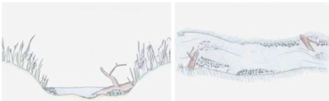
Figuur 6.3: Schets van het plaatsen van dood hout in de beek om opstuwingsplekjes te creëren. Deze dienen zigzaggend te worden aangebracht (zie rechter figuur).
