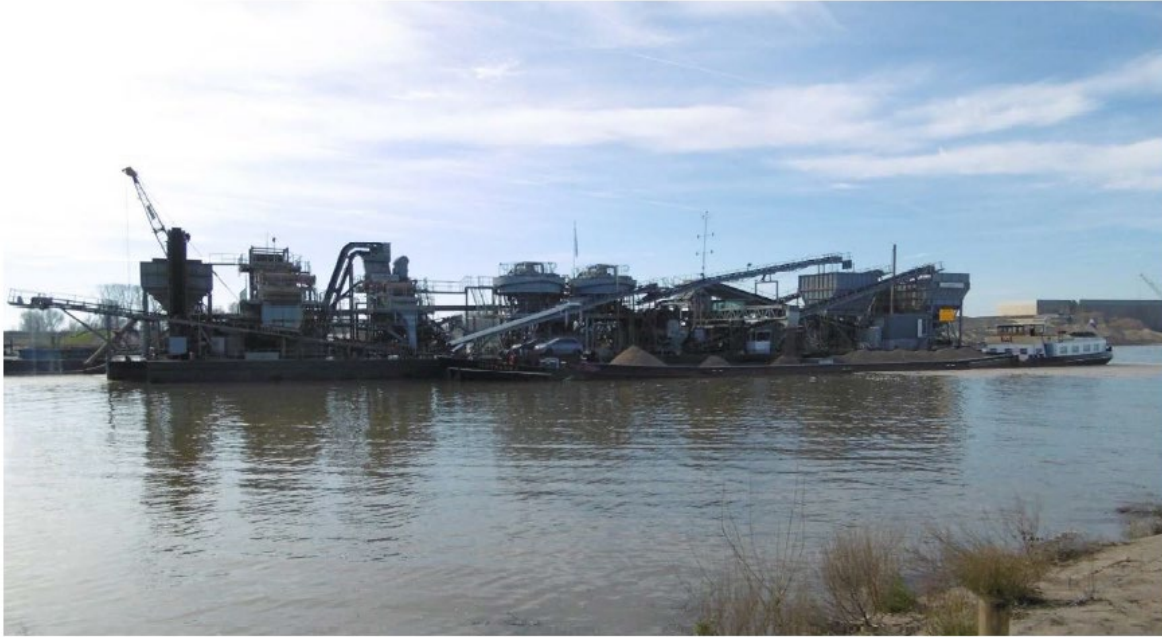
Afbeelding 7: Elektrische klasseerinstallatie Yvonne
